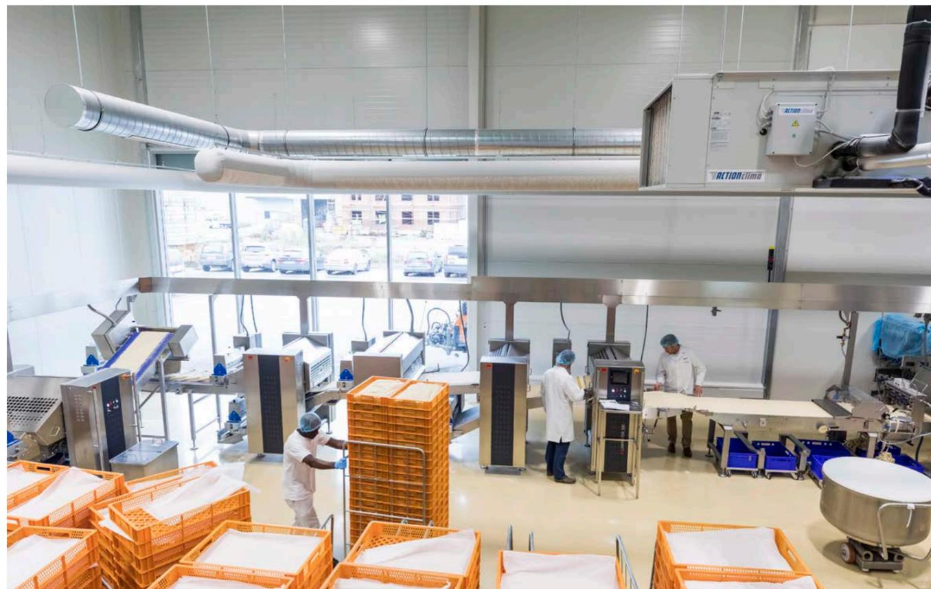
EINE GLEICHMÄSSIG KLIMATISIERTE RAUMUMGEBUNG SOWIE MEHLSTAUBABSAUGUNG SORGEN FÜR EIN ANGENEHMES RAUMKLIMA UND GLEICHMÄSSIGE PRODUKTQUALITÄT
